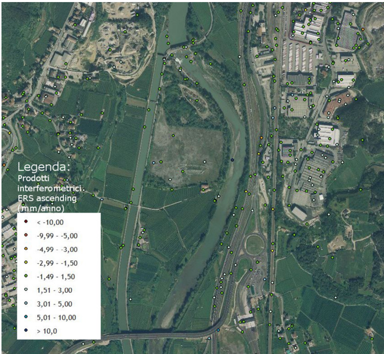
Figura 4. Abbassamenti al suolo di punti “riflettori” nell’area di studio – Dati satellitari ERS
